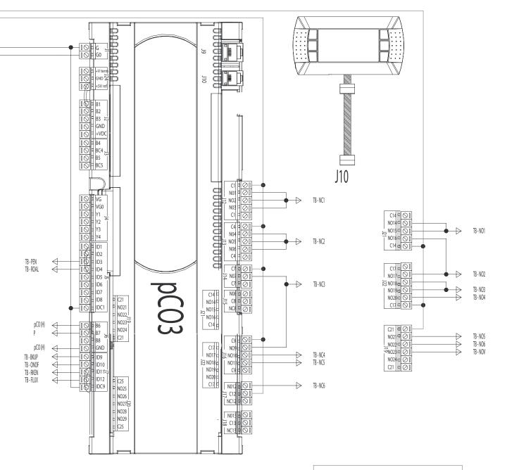
FORZA DI SERRAGGIO MORSETTI pCO3 Torque Force Terminals pCO3 (Nm) = 0,5 min-> 0,6 max
